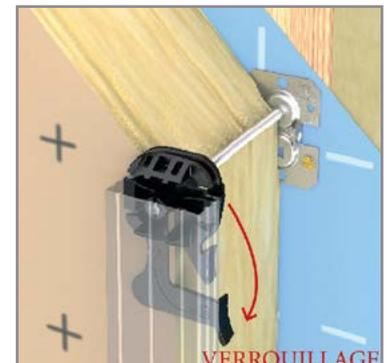
3. Placer un côté de la fourrure sur l'encoche de la tête de l'appui et la rabattre jusqu'au clipsage.
