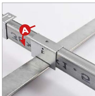
2. Positionner le porteur clip dans la suspente et plier le dépassement (A) vers le haut pour serrer le montage.
