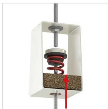
2. Insérez une tige filetée dans la partie inférieure du support. Traversez la partie en caoutchouc et fixez la tige au support à l'aide de la coupelle.
