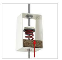
2. Insérez une tige filetée dans la partie inférieure du support. Traversez la partie en caoutchouc et fixez la tige au support à l'aide de la coupelle.
