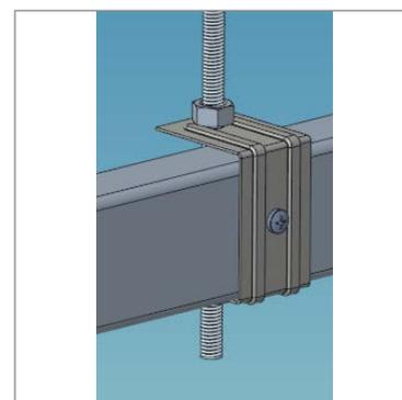
**3.** Maintien en position de l'ensemble avec un écrou et une vis.
