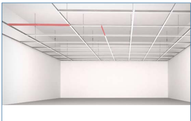
4. Mise en œuvre des entretoises
