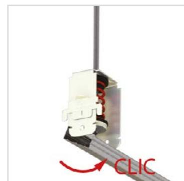
3. Clipser les ossatures sur les cavaliers en engageant une aile dans la fente horizontale et pivoter vers vous jusqu'au CLIC.
