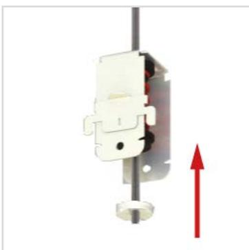
1. Insérer le cavalier sur la tige filetée puis régler sa hauteur en vissant la coupelle de sécurité.
