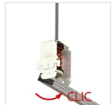
3. Clipser les ossatures sur les cavaliers en engageant une aile dans la fente horizontale et pivoter vers vous jusqu'au CLIC.
