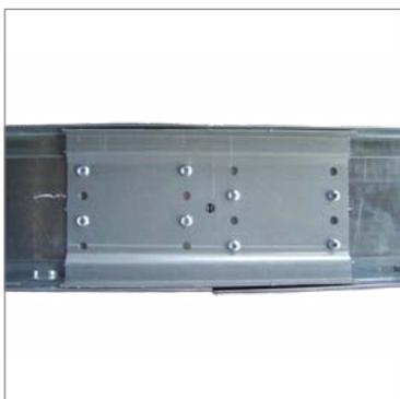
**1.** Positionnez les 2 profils en contact bout à bout et insérez la première éclisse. Centrez la grâce au trou central et vissez l'éclisse à l'aide des 8 trous diamètre 3 mm.
