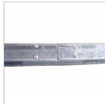
**3.** Mettez le profil sur sa hauteur et vissez les ailes des éclisses sur la semelle du profil. à l'aide de 4 vis. Retournez l'ensemble et effectuez la même opération sur l'autre semelle.
