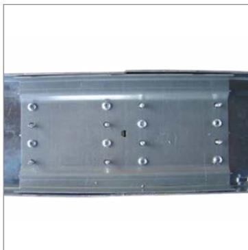
**2.** Tournez l'ensemble et positionnez la seconde éclisse en centrant sur les trous de diamètre 5 mm. Puis, vissez la seconde éclisse en utilisant les trous diamètre 3 mm.
