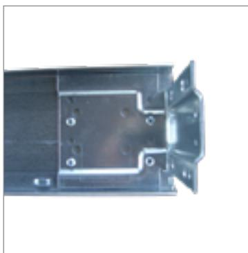
**2.** Poser l'OMNIFIX sur l'EMBOUT et le visser en utilisant les 4 trous diamètre 3 mm. Puis positionner le second EMBOUT en centrant les vis apparentes sur les trous diamètres 5 mm.
