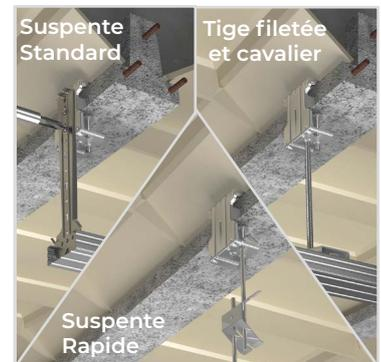
3. Fixer votre suspente dans la fente du grip à l'aide de 2 vis autoforeuses ou visser la tige filetée de 6 mm de diamètre dans le trou taraudé ou insérer votre suspente rapide dans le trou du grip prévu à cet effet.
